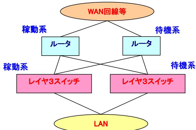
図 4-7 ネットワーク機器の冗長構成例
