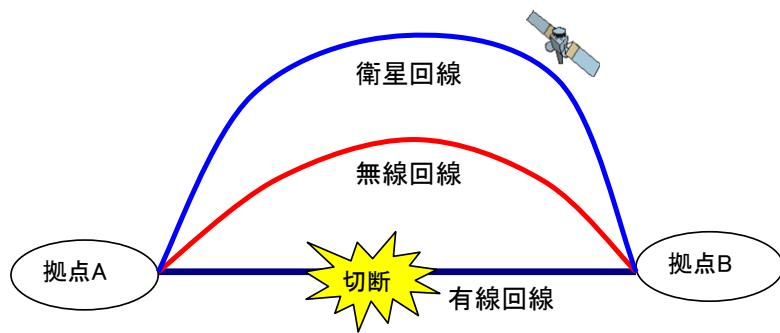
図 4-8 ネットワーク回線の冗長構成例
