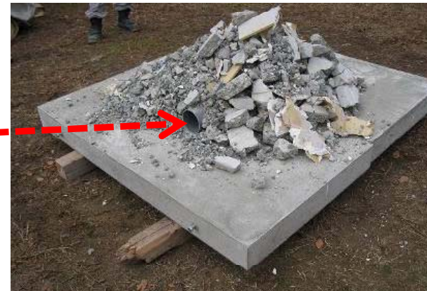
コンクリートや石エボード等の瓦礫(小片)を積み上げた場合の読み取り状況
