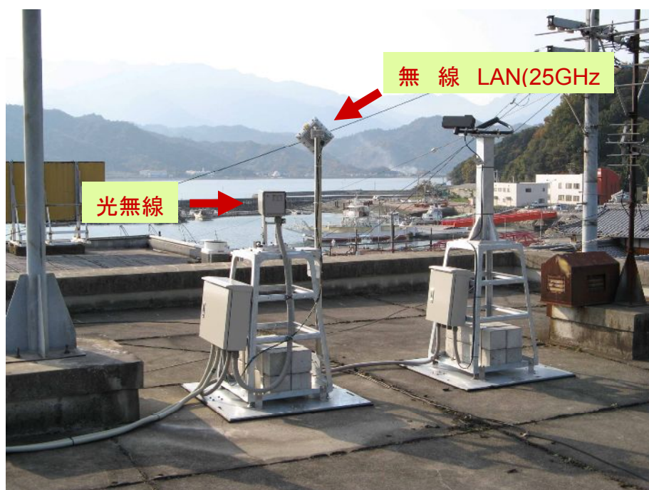
光無線+無線 LAN ハイブリッド伝送システムの離島での実証実験
